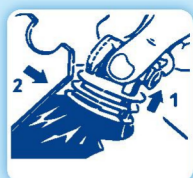
Izvući slavinu i učvrstiti je klapnom
